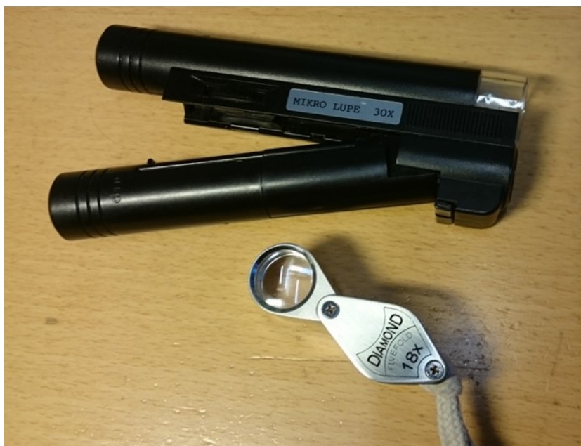
Figur 4. På grund af galmidernes ringe størrelse kræver det en lup med god forstørrelse 18-30x eller en egentlig stereolup at vurdere forekomsten. Foto Hans Peter Ravn.
